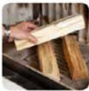
Das Holz locker in den Brennraum schichten.
